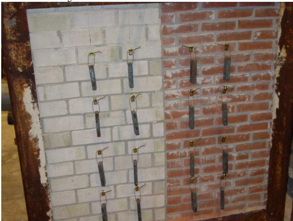
Foto 8: Beugels aan de kalkzandsteen- en baksteenwand.
