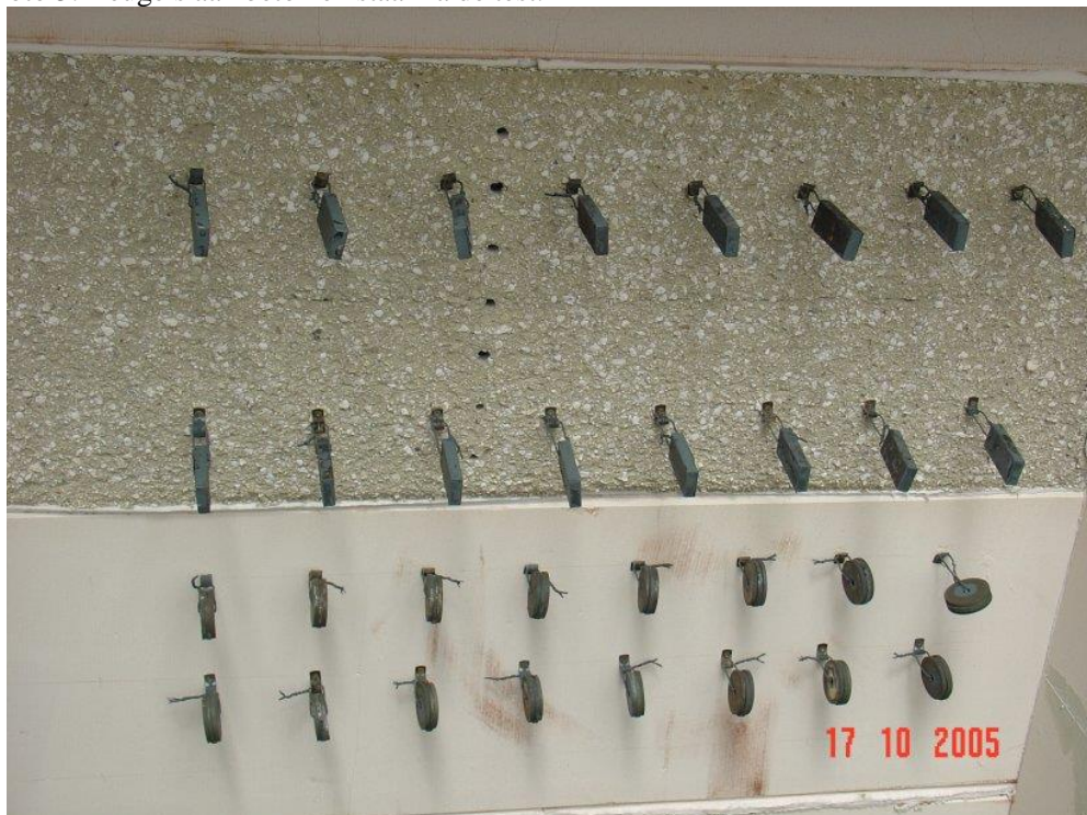
Foto 6: Beugels aan kanaalplaat en cellenbeton na de test.
