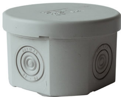
Boite de derivation ronde avec membrane - dia. ø80x404 entrées PG21IP65 - 750°
