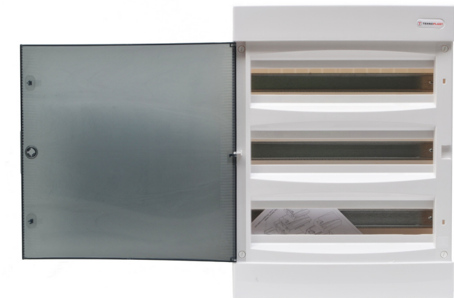
Verdeelkast opbouw - IP40 - 54 Modules (3x18)396 x 526 x 112 mm
