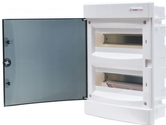
Coffret de Distribution à Encastrer - IP40 - 24 Modules (2x12)283 x 357 x 106 mm
