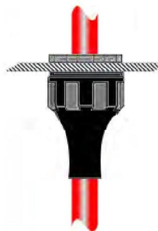
Quatre dimensions sont disponibles, convenant à une gamme de câbles de diamètre compris entre 14 mm et 67 mm.
