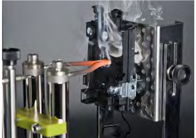
Glühdrahtprüfung (KADO) Glow wire test (KADO)
