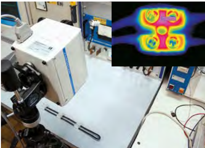
Wärmeprüfung, Temperaturverteilung mittels Thermokamera (EKL) Thermal test, temperature rise shown on thermal camera (EKL)
