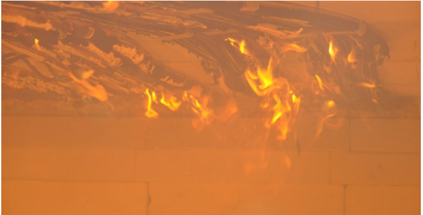
Funciebehoud systeem getest volgens DIN 4102 - 12
