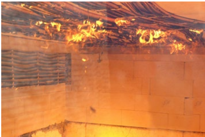
De JMV functiebehoud-systeemtest, E90 tot 1000° C.
