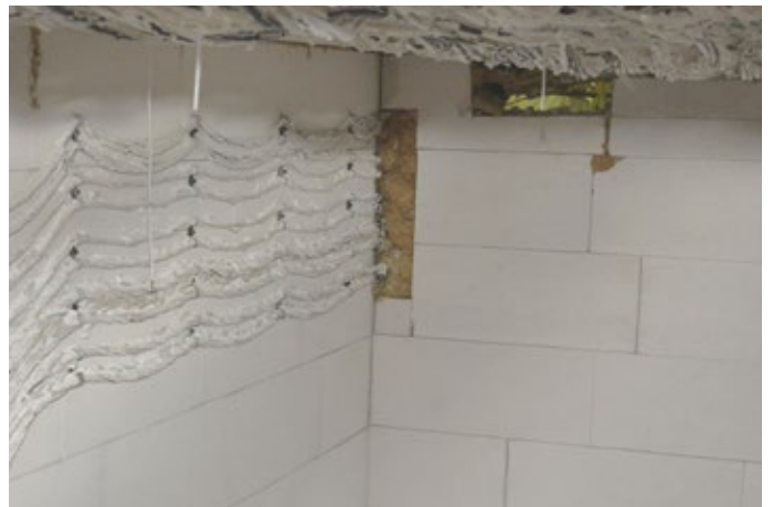
Het eindresultaat na 90 minuten functiebehoud-systeemtesten.
